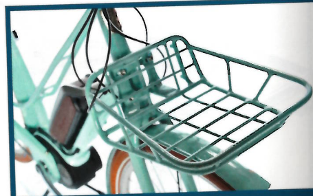
Der Frontgepäckträger ist am Steuerrohr verschraubt und trägt max. 15 Kilogramm
