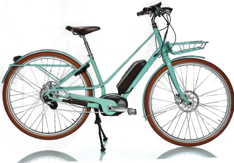
Der Frontgepäckträger ist am Steuerrohr verschraubt und trägt max. 15 Kilogramm
