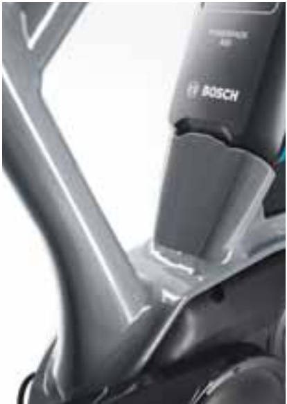
Klare Motor-Akku-Rahmen-Einheit, innenverlegte Kabel und glatte Schweißnähte
