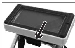
**HINWEIS. Um den Verlust von Fahrdaten zu verhindern, stellen Sie bitte sicher, dass die Steuerungseinheit ausgeschaltet ist, bevor sie vom Bike abgenommen wird.**
