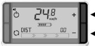
Les niveaux de générateur peuvent être commandés de manière similaire. Appuyez une fois sur la touche - pour activer le niveau 1 de générateur, et appuyez de nouveau pour passer aux niveaux supérieurs. Appuyez sur la touche + pour diminuer la production d'électricité d'un niveau.
