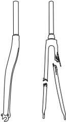
Figure 2.5 : **Gauche** : fourche métallique pliée en raison d'une surcharge **Droite** : la fourche en fibre de carbone a résisté à une charge bien plus lourde, mais s'est complètement cassée après la surcharge.
