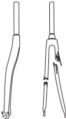
Abb. 2.5: **Links:** Durch Überlastung verbogene Metallgabel. **Rechts:** Carbongabel hielt höherer Belastung stand, brach bei Überlastung aber komplett durch.
