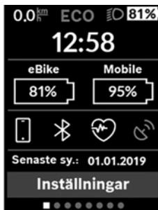
På statusskärmen visas bredvid statusraden även aktuellt klockslag, laddningsnivå för alla batterier på din eBike samt laddningsnivå för din smarttelefon, om den är ansluten via *Bluetooth*®.
