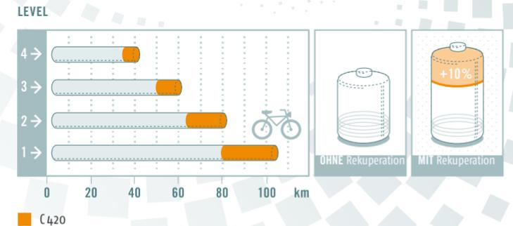
Die **RIDE+ Technologie** bringt dem Fahrer ein Zusatzplus an Leistung, die ihn je nach gewähltem Unterstützungsmodus um bis zu 200 % unterstützt. Die tatsächliche Reichweite hängt von vielen Faktoren ab und kann daher nur annäherungsweise angegeben werden: Softwareeinstellung, Kapazität des Akkus, Häufigkeit und Intensität der Rekuperation, Topographie, Straßenbelag, Reifenluftdruck, Gewicht, Fahrstil, Akku-Alter etc.
