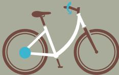
→ E-BIKE: Räder, die über einen Drehgriff „Gas“ geben. Der Motor ist aktiv, wenn man am Gasgriff dreht. Fahren ist auch ohne Treten möglich.
