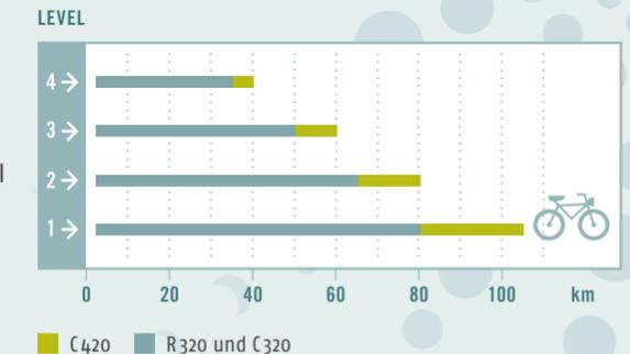
Die **RIDE+ Technologie** bringt dem Fahrer ein Zusatzplus an Leistung, die ihn je nach gewähltem Unterstützungsmodus um bis zu 200% unterstützt. Die tatsächliche Reichweite hängt von vielen Faktoren ab und kann daher nur annäherungsweise angegeben werden: Softwareeinstellung, Kapazität des Akkus, Häufigkeit und Intensität der Rekuperation, Topographie, Straßenbelag, Reifenluftdruck, Gewicht, Fahrstil, Akku-Alter etc.
