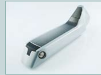
Unterrohr-Akku C420 (420 Wh · 48 V · 8,8 Ah), auch als C320 (320 Wh) erhältlich
