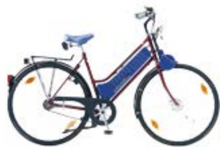
1992 Diamant Cityblitz Modell 784, Leichtmofo Rahmenmaterial: von Hand gelöteter Chrom-Molybdän-Stahlrahmen
