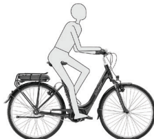
Figura 1.2: Regolazione dell'altezza della sella.
