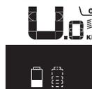
Se in una eBike con due batterie inserite verranno caricate entrambe le batterie, sul display verrà visualizzato l'avanzamento della carica per entrambe le batterie (nella figura, la batteria in fase di carica è quella sinistra). L'indicazione lampeggiante sulla batteria indicherà anche quale delle due batterie si trovi al momento in fase di carica.
