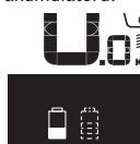
Pokud se u systému eBike se dvěma nasazenými akumulátoři na jízdním kole nabíjejí oba akumulátoru, na displeji se zobrazuje postup nabíjení obou akumulátorů (na obrázku se právě nabíjí levý akumulátor). To, který z obou akumulátorů se právě nabíjí, poznáte také podle blikajícího ukazatele na akumulátoru.
