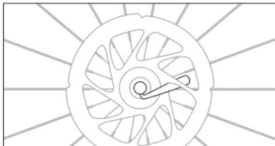
Abb. 1.7: Ein inkorrekt positionierter Schnellspanner kann mit dem Bremssystem in Kontakt kommen.
