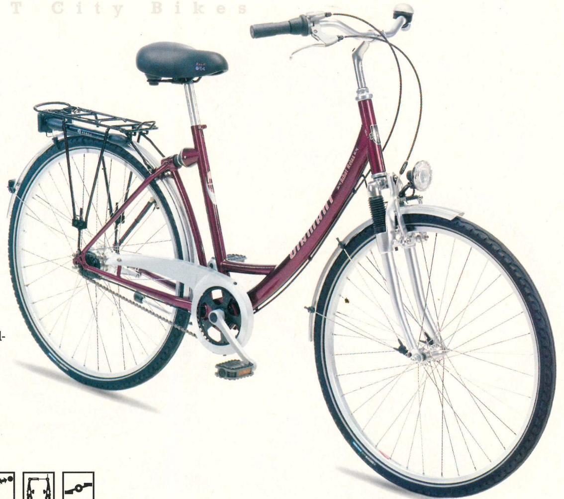
**D**ie Elastomer-Hinterbaufederung und die Federgabel vorn bügeln Straßenunebenheiten oder Kopfsteinpflaster einfach weg. Die Impac-Speedpower-Bereifung sorgt für optimale Roll-eigenschaften und hat zusätzlich einen Reflexstreifen.
