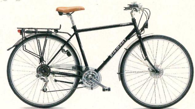
**B**is auf die Elastomer-Federung und die Federgabel mit dem Testsieger Seneka Relax identisch – also auch mit komfortablem Moonbügel-Lenker, konsequenter Doppelverkabelung, Schwalbe Hurricane GX Reflex Reifen und, und, und ...
