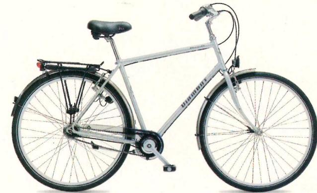
**D**as Citybike mit dem sportiven Charakter: Gemuffter, silberner CrMo-Oversize-Rahmen für Damen und Herren, V-Bremsen mit Powermodulator, Lenkervorbau mit Flip-Flop-Wechselsystem. Die Sitzposition ist aufrecht und bequem.
