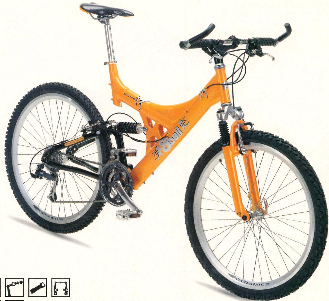
**Rahmenvariante** Alu 7005 Y-Style Rahmen, geschweißt; Hinterbaufederung mit Federgabel Suntour SR MG 91
