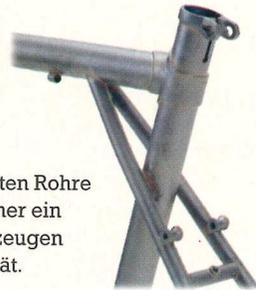
**T**echnik vom Feinsten: Neuer, spezialgemuffter CrMo-Oversize Rahmen mit endverstärkten Thron-Rohren von Columbus, Mohican-Lenker und die komplette XT-Gruppe von Shimano. Dieses Modell setzt Maßstäbe im Trekkingbereich bei nur 14,9 kg.
