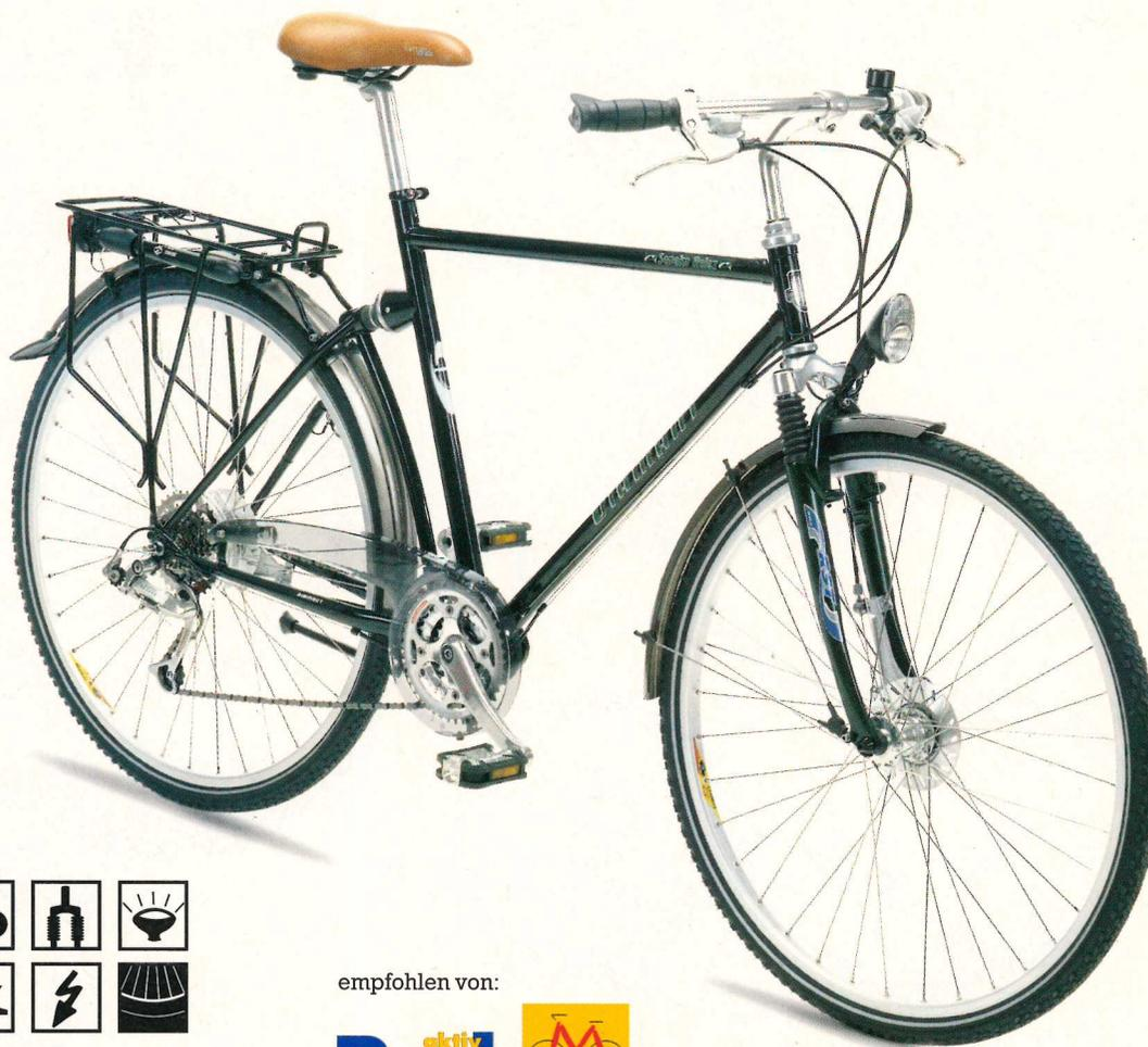
**T**rekking mit Komfort. Gabel und Heck gefedert, äußerst zuverlässige und wartungsfreie Rollenbremse, Shimano-Nexave-Schaltsystem und viele weitere Extras. Vom ADAC empfohlen und im „aktiv Radfahren“-Test ausgezeichnet.
