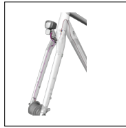
Acheminement des câbles - feux (fourche rigide)
