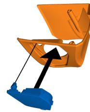
4. Kappe montieren – beim Aufsetzen die Seitenteile nach außen ziehen und einrasten lassen.
