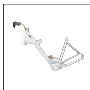
Prowadzenie przewodów — system elektryczny
